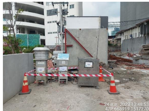
รูปที่ 31 ติดตั้งเครื่องตรวจวัดคุณภาพอากาศ
